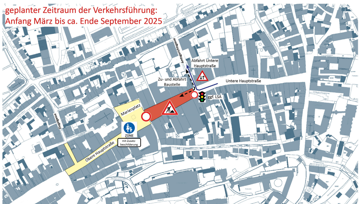
SCHEMATISCHE DARSTELLUNG DER GEPLANTEN VERKEHRSFÜHRUNG IM BEREICH UNTERE HAUPTSTRASSE ZU BEGINN DER MASSNAHME. ES GILT DIE TATSÄCHLICHE BESCHILDERUNG UND STVO.
